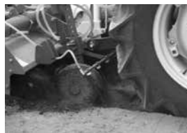
乗用トラクター装着散布混和 テスト風景
